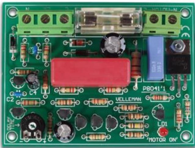
Permette, tramite un singolo tasto, di controllare sia un ventilatore che una luce. Funzione di spegnimento automatico della ventola con ritardo regolabile, utilizzabile per esempio in cucine o bagni.
