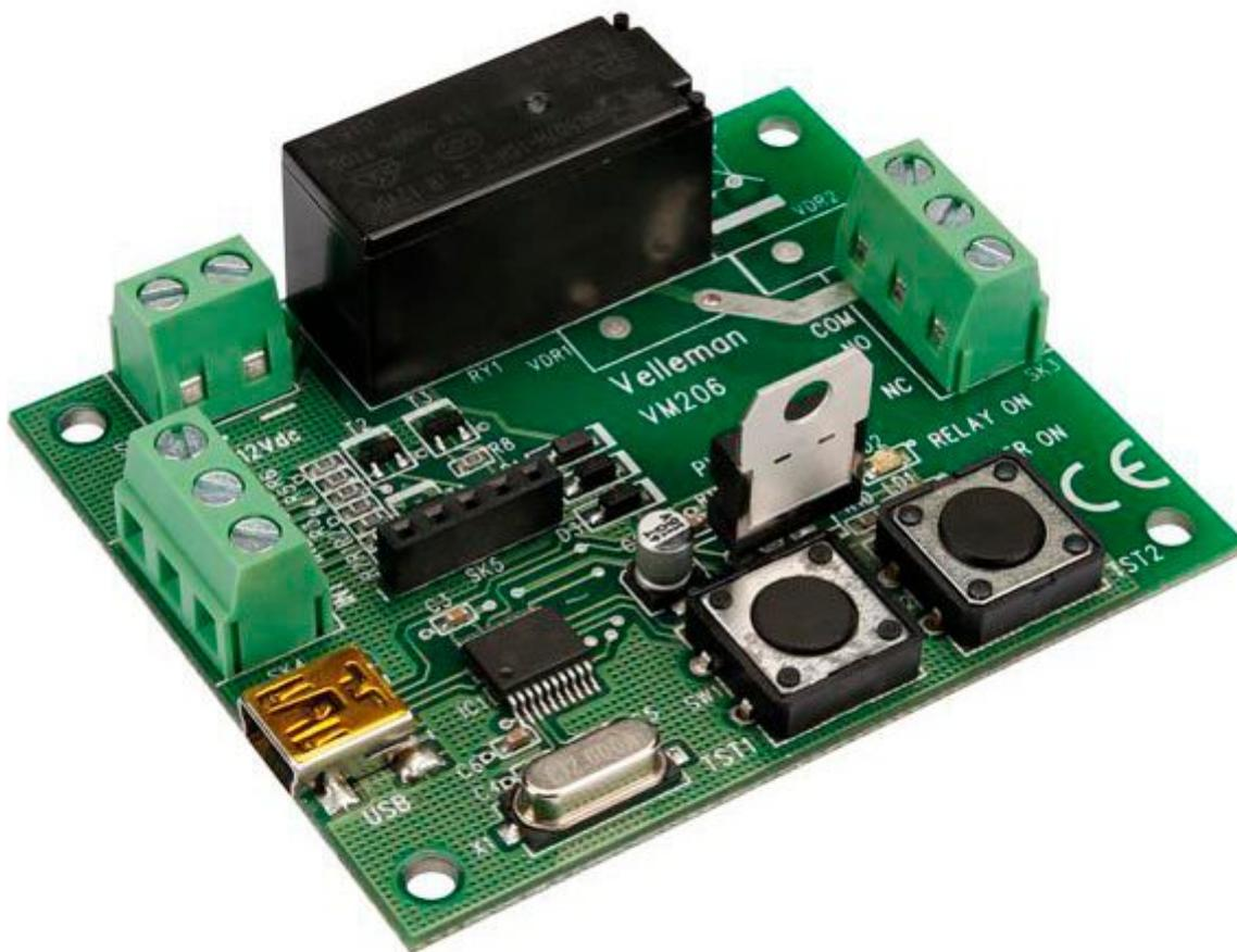
Timer universale dotato di ampia varietà di modalità di funzionamento. Nel caso le impostazioni predefinite disponibili non si adattino alle nostre esigenze, il timer può essere configurato e adattato, tramite PC, grazie al software in dotazione e all'interfaccia USB di cui dispone.
