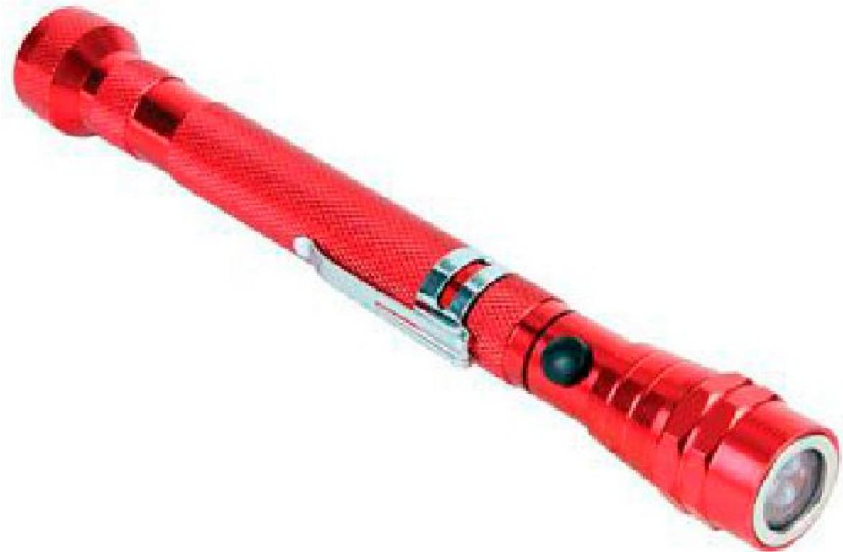
Torcia dotata di 3 LED ad alta luminosità, corpo telescopico da 55,5 cm (non allungato 18 cm) e parte frontale con magnete in grado di attirare e trasportare oggetti con peso massimo di 2,2 kg. Ideale per individuare e raccogliere viti, dadi, bulloni e piccoli oggetti metallici in luoghi bui e difficili da raggiungere. Completa di batterie (4 batterie tipo LR44/AG13) e clip di fissaggio. Peso: 111g.
