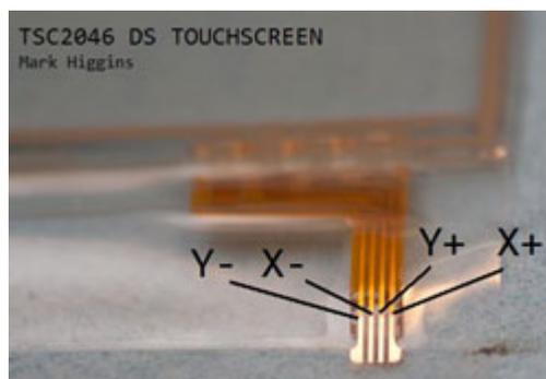
Touch screen analogico a 4 contatti utilizzabile in numerose applicazioni. La posizione della pressione sul display, si ottiene facilmente utilizzando due ingressi analogici di un microcontrollore o un Touch-Screen Controllers tipo il TSC2046. Dimensioni: 69,85 mm x 55,80 mm. Ideale per essere utilizzato come touch screen su qualsiasi display LCD (con le stesse dimensioni).
