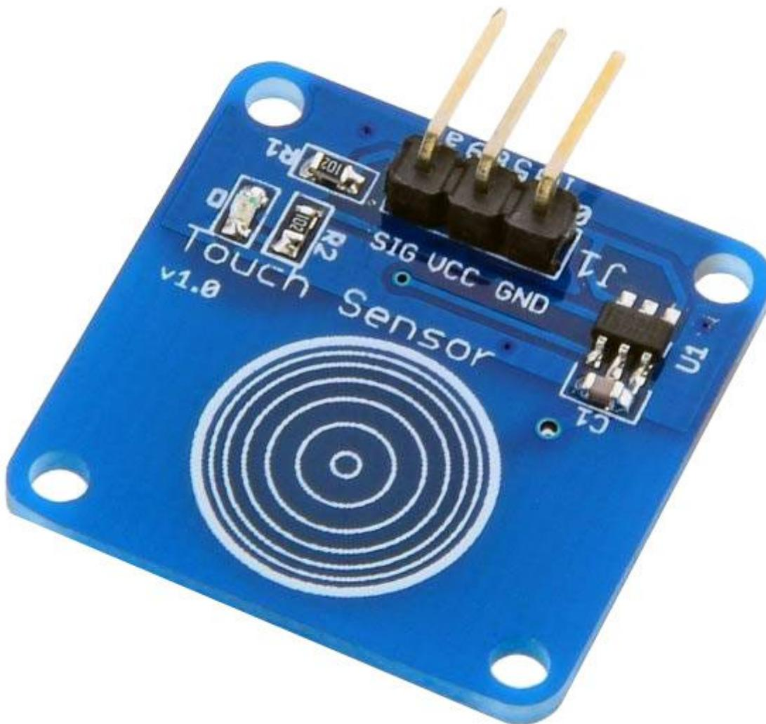
Piccolo modulo con la funzione di sensore touch. Basato sul chip TTP223B, normalmente l'uscita è a livello basso, quando un dito tocca l'area sensibile l'uscita passa a livello alto. Può essere utilizzato per sostituire i tradizionali pulsanti meccanici, con Arduino o compatibili per altre applicazioni.
