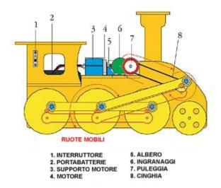
Modello motorizzato in legno facilmente realizzabile da chiunque. Consente di prendere confidenza con i sistemi di trasmissione del moto, dagli ingranaggi alle pulegge. Non richiede l'impiego di un saldatore né di alcun tipo di colla. Dimensioni: 218 x 95 x 150 mm.
