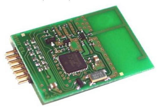
Il transceiver a lungo raggio XTR-CYP-24 implementa il modulo Cypress CYWM6935 LRTM 2.4GHz DSSS Radio SoC e ne aumenta la potenza RF (ERP) fino a 15 dBm (rispetto a 0 dBm del modulo originale) consentendo di raggiungere una portata di circa 150 metri. Opera nella banda libera ISM (Industrial, Scientific and Medical) a 2.4GHz e offre un sistema radio completo per l'integrazione in dispositivi nuovi o esistenti. Soluzione ideale per automazione domestica e industriale.
