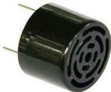
Trasduttore ad ultrasuoni impiegato nei sensori Maxbotix EZ0, EZ1 ed EZ2. Livello di pressione sonora (SPL): 117dB (0dB=0,2n bar), sensibilità (SEN): -60dB (0dB 1V/u bar), impedenza: 1 kohm, ringing: meno di 1ms, capacità: 2400 pF (+/- 20%), frequenza di funzionamento: da 38 kHz a 42 kHz, drive voltage: 20 V RMS massimo e range di temperatura: da -40°C a +65°C.
