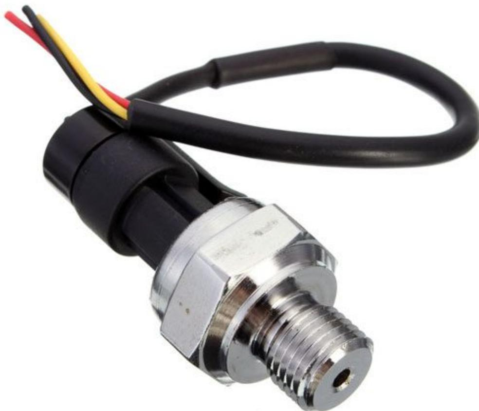
Questo trasduttore permette di misurare la pressione di gas o liquidi non corrosivi. Dispone di un range di pressione da 0 a 0,5 MPa, tempo di risposta di circa 2 ms, uscita analogica e attacco filettato G ¼ pollice. La tensione di uscita è direttamente proporzionale alla pressione.
