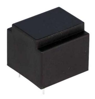
Trasformatore di misura di tensione della Itacoil. Accetta in ingresso valori di tensione da 100VAC a 275VAC con un errore di linearità tipico minore di ±0,50%. Dispone di due secondari che, a seconda di come sono collegati, permettono di ottenere una determinata tensione di uscita. Con una tensione nominale di ingresso pari a 230 VAC, collegando i secondari in serie si misura agli estremi liberi una tensione di 10Veff. La resistenza di carico da usare in questo caso è pari a 10 kohm.
