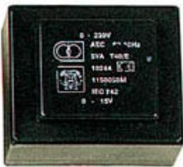
Trasformatore resinato da circuito stampato con potenza di 2,5 VA in grado di fornire in uscita una tensione di 9 V / 0,278 A.
