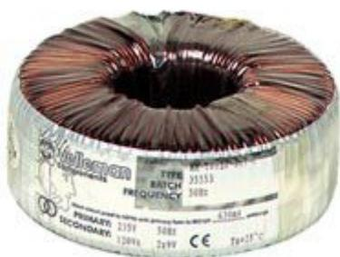
Trasformatore toroidale rispondente alle norme EN 60742/BS3535 in grado di erogare una tensione sul secondario di 2x30 Vac. Potenza massima 120 VA.
