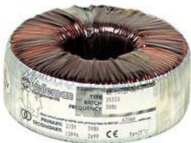
Trasformatore toroidale rispondente alle norme EN 60742/BS3535 in grado di erogare una tensione sul secondario di 2x24 Vac. Potenza massima 160VA.
