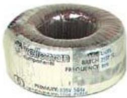
Trasformatore toroidale rispondente alle norme EN 60742/BS3535 in grado di erogare una tensione sul secondario di 2x21 Vac. Potenza massima 300 VA.
