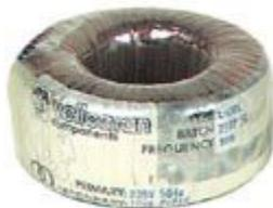
Trasformatore toroidale rispondente alle norme EN 60742/BS3535 in grado di erogare una tensione sul secondario di 2x18 Vac. Potenza massima 30 VA.
