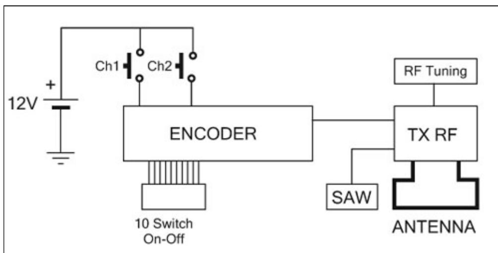
Trasmittitore palmare a 2 canali con risuonatore SAW, ideale per applicazioni nel campo antifurto e comandi codificati. Alimentazione: batteria 12V, consumo: 10 mA, frequenza: 433.92 MHz, canali: 2, Encoder: HT12E, potenza irradiata: 1 mW, combinazioni: 4096 bit, dimensioni (mm): 65,5x37x15 (Codice Aurel: 8110-TX12E-2TK, 650201001G). Conforme alle Normative Europee EN 300 220, EN 301 489 ed EN 60950.
