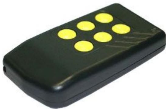
Trasmettitore palmare RF a codice dinamico e risonatore SAW a sei canali. Contenitore ergonomico. Ideale per applicazioni ove si richiedano comandi codificati, alta efficienza e bassa emissione di spurie. Conforme alle Normative Europee. Modulazione: AM (OOK), Alimentazione: batteria 12 Vdc, Assorbimento: 7 mA, Frequenza: 433.92 MHz, Potenza (E.R.P.): 1 mW, Canali: 6, Encoder: HCS301, Dimensioni: 40 x 75 x 16 mm.
