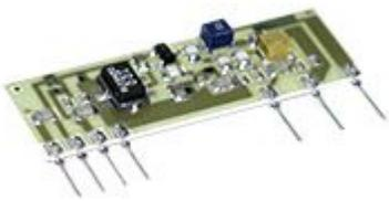
Modulo trasmettitore SAW con antenna esterna ideale in applicazioni dove si voglia modulare on-off una portante R.F. con dati digitali. Caratterizzato da alta efficienza e bassa emissione di armoniche. In accordo con le Normative Europee. Utilizzabile con: Ricevitori AM OOK 433.92. Alimentazione: 5 V, Consumo: 4 mA, Frequenza: 433.92 MHz, Potenza d'uscita: 10 mW, Bit rate: 9600 bps, Dimensioni: 38.1x13.2x3 mm (Codice Aurel: TX-SAW433/s-Z RFM, 650200689).
