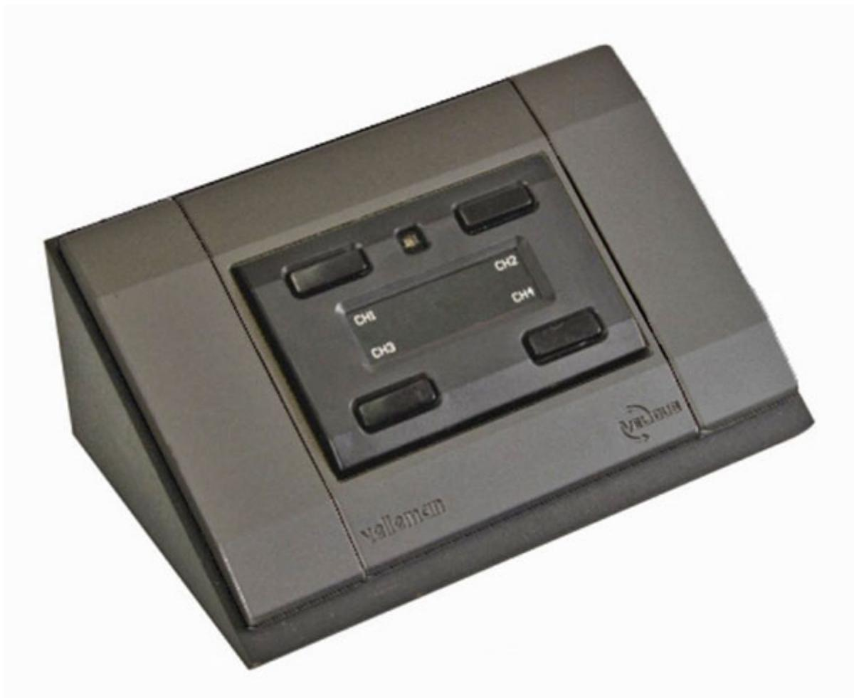
Trasmettitore a quattro canali completo di supporto da tavolo in legno. Operante sui 433,92 MHz con codifica a 32 BIT con oltre 1 miliardo di possibili combinazioni. Adatto a funzionare col ricevitore a 4 canali cod. 8220-VM160. Possibilità di montaggio a parete e personalizzazione dell'etichetta di ogni pulsante.
