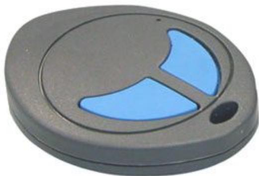
Trasmettitore FM palmare a 2 canali a 868 MHz di ridotte dimensioni con encoder HCS300. Ideale per applicazioni di controllo remoto ad elevato grado di sicurezza. Notevole autonomia grazie alla batteria al Litio a 3V. Consumo nullo in Stand-by. Conforme alle Normative Europee EN 300 220, EN 301 489 ed EN 60950.
