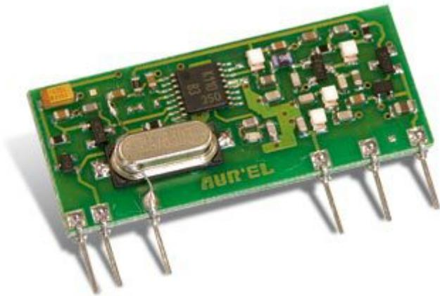
Modulo trasmettitore PLL in modulazione di frequenza (2FSK) con antenna esterna per applicazioni RF con dati digitali. Il modulo è pin-to-pin compatibile con la serie di trasmettitori OOK AUREL. Consumo nullo in assenza di segnale modulante. Caratteristiche principali: Frequenza: 868.3 MHz, Potenza d'uscita: 6 mW, Bit rate: 9600 bps, Dimensioni: 39x17.5x5 mm, Alimentazione: 5 V, Consumo: 24 mA.
