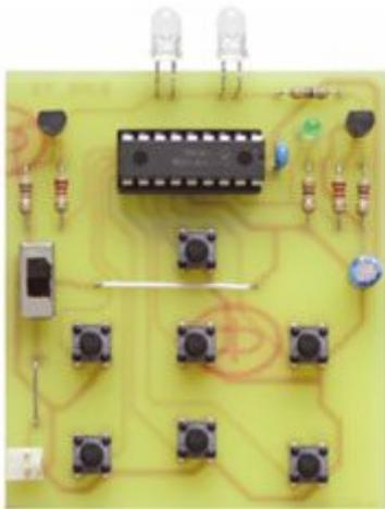
Telecomando a raggi infrarossi in scatola di montaggio, dispone di sei pulsanti di comando, presa di alimentazione e un interruttore ON/Off. Da utilizzare come parte di ricambio per il Robot Spiderin (vedere prodotti correlati).
