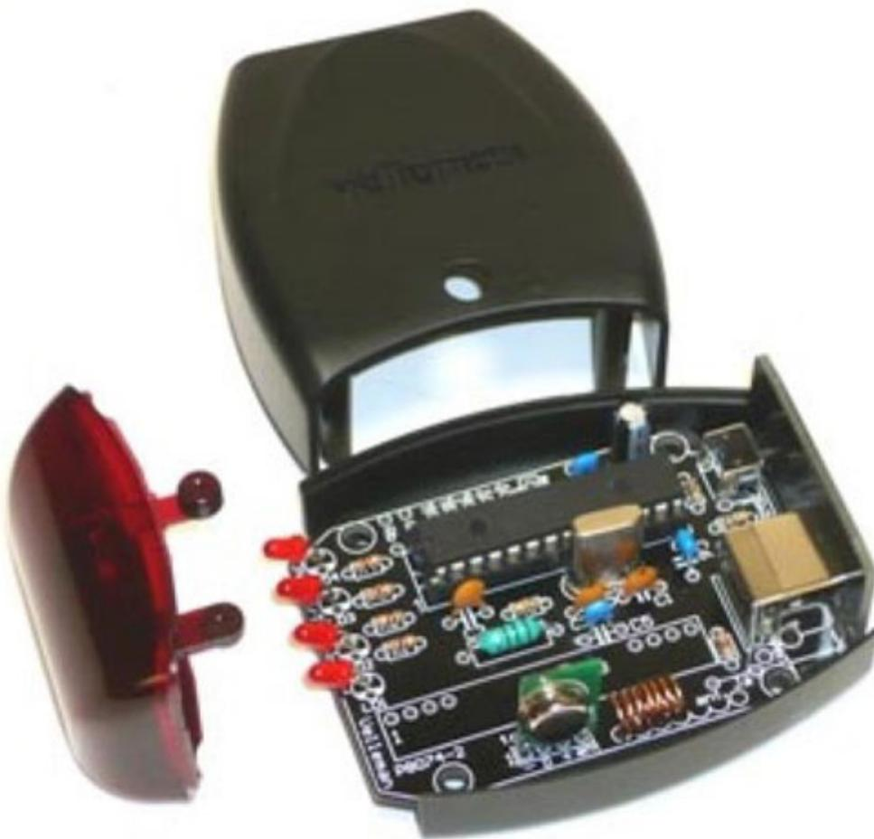
Permette di trasformare il proprio computer in un efficiente telecomando; basta collegarlo alla porta USB del PC, installare il driver ed il gioco è fatto! Si utilizza in abbinamento alla scheda K8056 (dotata di RX433N), K8070 o VM119. Permette di controllare fino a 255 ricevitori (max. 2040 canali). Driver, software d'esempio e librerie DLL (per creare le proprie applicazioni) disponibili su [www.velleman.be](http://www.velleman.be).
