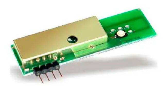
Modulo trasmettitore SAW con antenna integrata, ideale per applicazioni ove sia richiesta la massima potenza irradiabile e il minimo ingombro in termini di spazio occupato.
