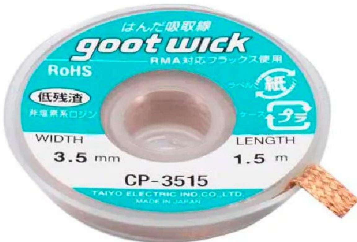
Sottile e morbida trecciola di rame larga 3,5 mm. Permette di rimuovere lo stagno sciolto con il saldatore, consentendo di dissaldare facilmente i componenti elettronici o di rimuovere lo stagno in eccesso. Consigliata anche per leghe di stagno senza piombo. Lunghezza 1,5 metri.
