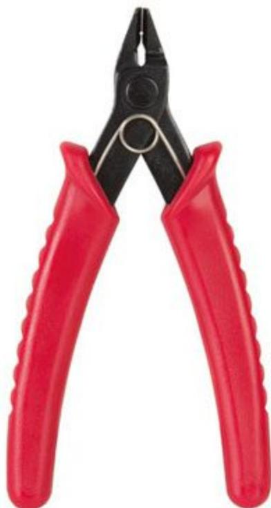
Pratico utensile con doppia funzione che può essere utilizzato sia come tronchesino, per tranciare cavi con diametro massimo di 1,2 mm, che come spelafili per cavi da 20 a 24 AWG. Lunghezza: 120 mm.
