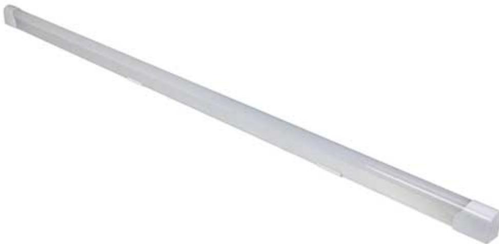
Lampada con tubo tipo neon ma a LED bianchi in SMD (tipo 2835). Colore: bianco neutro, temperatura colore: 4000 K, flusso luminoso: 1600 lumen, alimentazione 220 Vac, consumo 20 watt. Durata media 30.000 ore di vita.
