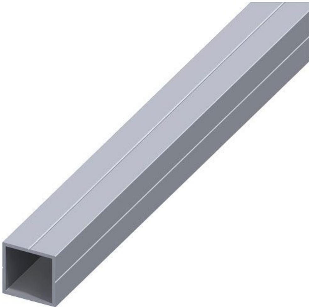
Tubo in alluminio naturale, sezione quadrata, scanalature longitudinali su tutti i lati per facilitare la foratura. Lunghezza 1 metro. Dimensioni (mm): 23,5x23,5; spessore 1,5 mm.
