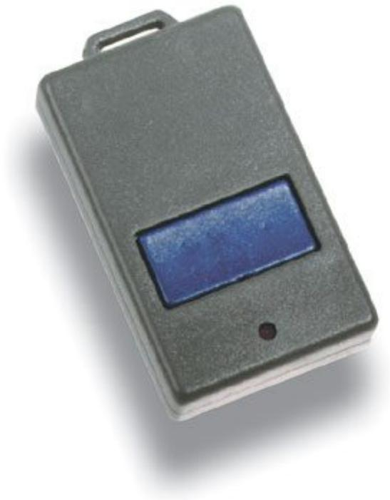
Trasmettitore palmare monocanale con filtro SAW, ideale per applicazioni in antifurti, controllo remoto e sistemi codificati. Utilizzabile con ricevitori AM OOK 433.92. Alimentazione: batteria 12V, Consumo: 10 mA, Frequenza: 433.92 MHz, Canali: 1, Encoder: 145026, Dimensioni: 65.5x37x15 mm (Codice Aurel: TX-1TK-SAW 433, 650200134).
