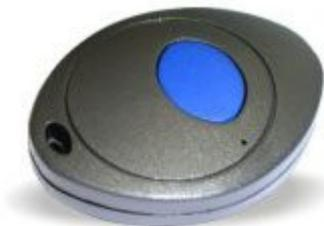
Trasmettitore palmare monocanale di ridotte dimensioni con encoder HCS 300. Elevate prestazioni grazie all'impiego di batteria al Litio a 3V. Consumo nullo in Stand-by. In accordo con le Normative Europee. Utilizzabile con: RX4M50FM60. Alimentazione: batteria 3V, Consumo: 10 mA, Frequenza: 433.92 MHz, Canali: 1, Encoder: HCS300, Dimensioni: 54x43x15 mm (Codice Aurel: HCS-FM-TX1, 650200611).
