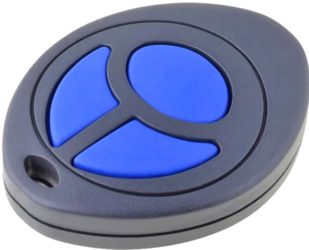
Trasmettitore palmare a 3 canali di ridotte dimensioni con encoder HCS 300. Elevate prestazioni grazie all'impiego di batteria al Litio a 3V. Consumo nullo in Stand-by. In accordo con le Normative Europee. Utilizzabile con: RX4M50FM60. Alimentazione: 3 V, Consumo: 10 mA, Frequenza: 433.92 MHz, Canali: 3, Encoder: HCS300, Dimensioni: 54x43x15 mm. (Codice Aurel: HCS-FM-TX3, 650200613).
