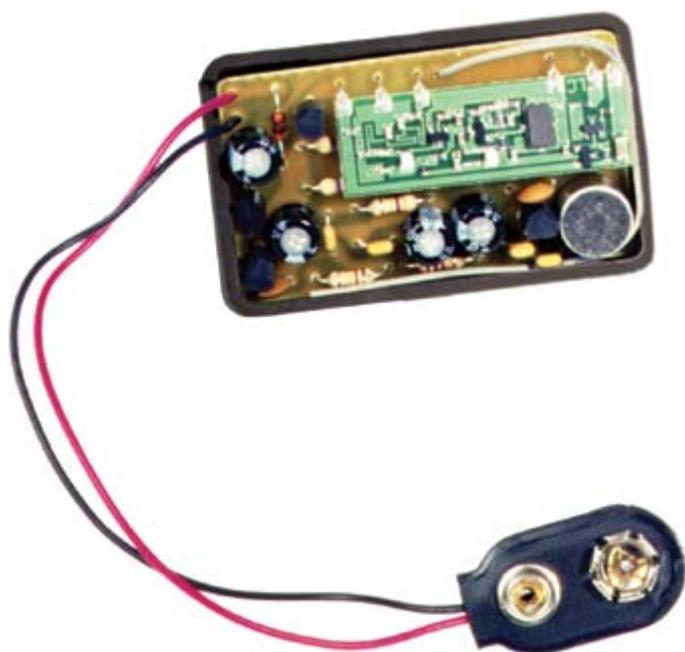
Minitrasmettitore audio via radio che abbinato al relativo ricevitore (FT407 non incluso) permette di ascoltare a distanza quel che avviene in qualsiasi ambiente. Lavora nella nuova banda UHF degli 868 MHz e consente una portata compresa tra 50 e 200 metri. Utilizza dei comuni moduli Aurel solitamente usati nei controlli a distanza. Le scatole di montaggio comprendono tutti i componenti, i moduli Aurel, la basetta, il contenitore e tutte le minuterie.
