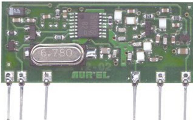
Modulo trasmettitore in modulazione di frequenza con antenna esterna per applicazioni RF con dati digitali. Potenza massima di uscita 10 dBm, tensione di alimentazione compresa tra 2,7 e 5 volt.
