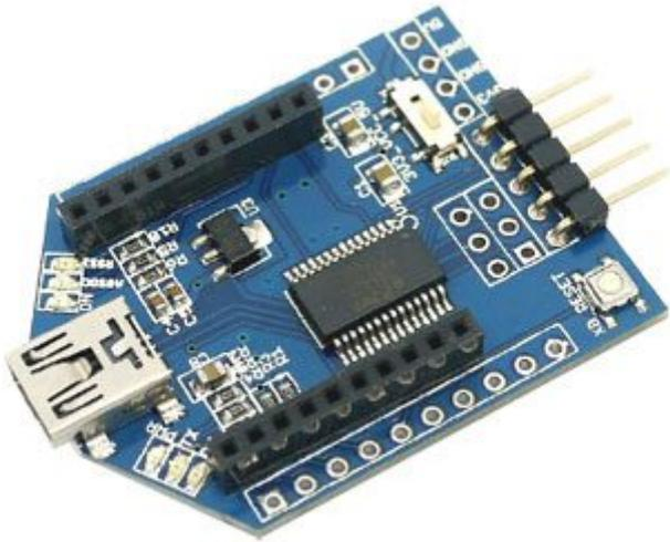
Convertitore USB-seriale che permette di dotare i vostri progetti di connessione USB. Viene utilizzato per gestire la scheda RAIMBOWDUINO e gli strip di cui è dotato permettendo una facile implementazione con altre schede. Possibilità di montare un modulo XBee o Bluetooth (7300-BLUETBEE), permettendo in questo modo di ottenere una connessione wireless con il PC.
