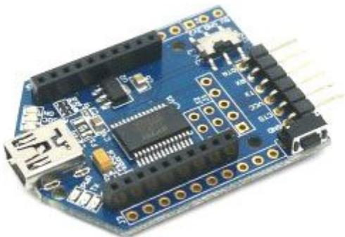
Convertitore USB-seriale che permette di dotare i vostri progetti di connessione USB. Può essere utilizzato per la programmazione, oppure montando moduli XBee o Bluetooth (7300-BLUETBEE), ottenere una connessione wireless con il PC.
