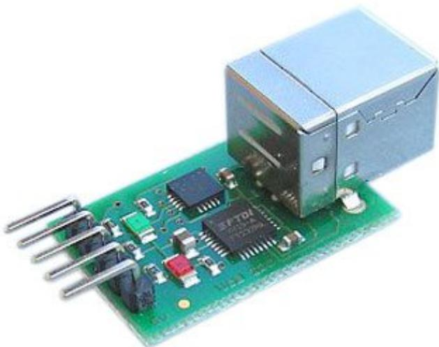
Il modulo USB-I2C permette di collegare dispositivi con bus I2C (solo in modalità I2C master) alla porta USB del PC. Ideale per essere utilizzato con i sensori SRF02 e SRF08.
