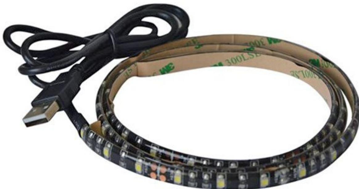
Strip luminosa indirizzabile contenente 30 LED a luce calda. Base autoadesiva 3M, distanza tra LED circa 16,5 mm, può essere tagliato ogni 3 LED, alimentazione: 5 VDC (tramite porta USB del PC o alimentatore con uscita USB del TV o qualsiasi altro dispositivo), lunghezza: 50 centimetri.
