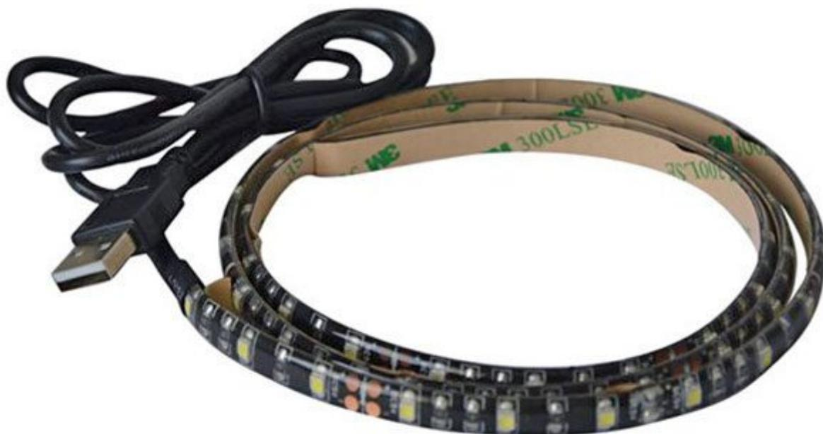
Strip luminosa indirizzabile contenente 30 LED a luce fredda. Base autoadesiva 3M, distanza tra LED circa 16,5 mm, può essere tagliato ogni 3 LED, alimentazione: 5 VDC (tramite porta USB del PC o alimentatore con uscita USB), lunghezza: 50 centimetri.
