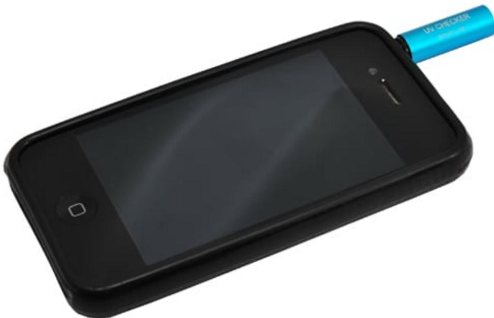
Rilevatore di raggi ultravioletti per smartphone, basato su un piccolo sensore a semiconduttore. Si inserisce direttamente nella presa cuffie di uno smartphone, sul quale deve essere installata l'apposita App gratuita (disponibile per Android e iOS), ed è in grado di rilevare la radiazione UVA/UVB. Non necessita di alcuna sorgente di alimentazione, si alimenta direttamente dalla presa cuffie dello smartphone.
