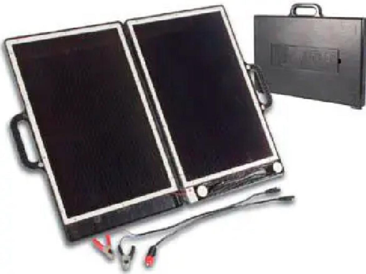
Modulo amorfo da 13 watt contenuto all'interno di una valigetta adatto per la ricarica di batterie a 12 volt. Dotato di serie di differenti cavi di collegamento, può essere facilmente trasportato e installato ovunque. Potenza di picco: 13 W, tensione di picco: 14 V, corrente massima: 750 mA, dimensioni: 510x375x40 mm, peso: 4,4 kg.
