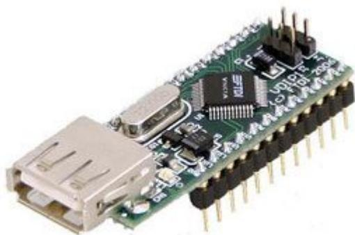
Prodotto dalla FTDI il VDIP1 è il primo modulo USB Host disponibile sul mercato: interfacciato ad un microcontrollore dotato di porta seriale, SPI (Serial Peripheral Interface) o parallela, permette di controllare diversi tipi di periferiche.
