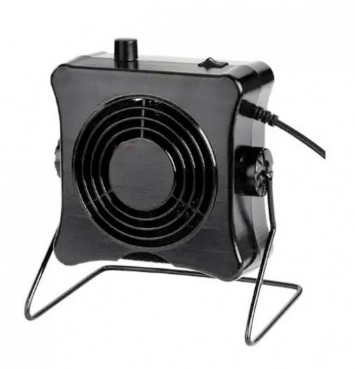
Aspirafumi per saldatura con filtro a carboni attivi. Dotato di regolazione della velocità, è in grado di funzionare anche come ventilatore da tavolo. Elimina i fumi nocivi di saldatura, resine varie e fumi di pirografo dalla postazione di lavoro. È in grado di estrarre i fumi in posizione verticale anche quando è appeso. Il filtro a carboni attivi può essere facilmente sostituito (vedere prodotti correlati).
