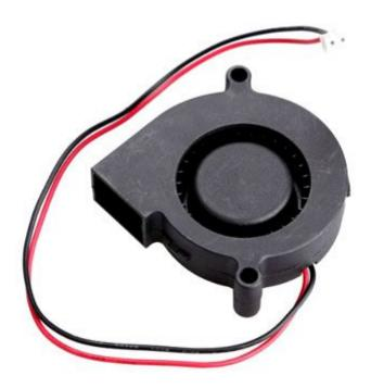
Ventola di raffreddamento con flusso d'aria laterale. Materiale termoplastico, alimentazione: 5 Vdc, corrente: 0,12 A, dimensioni (mm): 50x50x15, temperatura di funzionamento: da -10°C a +60°C, vita media (a 40°C): circa 40.000 ore.
