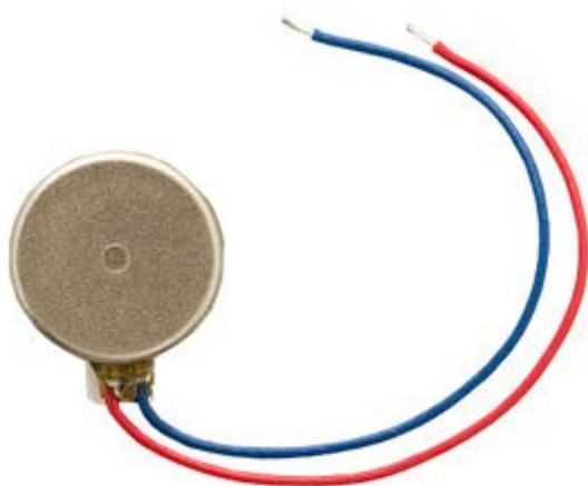
Piccolissimo motore a vibrazione ideale in tutte quelle applicazioni dove non è possibile utilizzare segnalatori acustici. Tutte le parti in movimento sono protette all'interno. Alimentazione 2-3,6 Vdc. Il motore viene fornito con un supporto adesivo 3M (per il fissaggio). Dimensioni: diametro 10 mm - spessore 3,4 mm - peso: 1,2 grammi.
