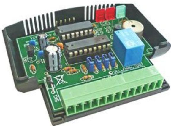
Compatto modulo dotato di microcontrollore (PIC16F630) che permette di controllare automatismi quali controller, dispositivi per autoveicoli, ecc... sfruttando i 4 ingressi e le 4 uscite open collector, un LED, l'uscita a relé (NO/NC, 2A) ed il buzzer disponibili sulla scheda. Potrete concentrarvi sullo sviluppo del software senza preoccuparvi dell'hardware! Tutto ciò di cui avete bisogno è un programmatore di pic compatibile con il modello PIC16F630 (connettore ICSP™ presente su scheda).
