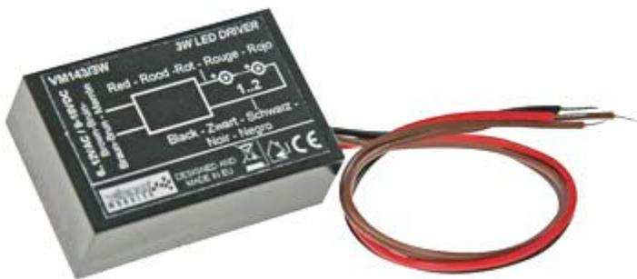
Modulo in grado di alimentare fino a due LED con una potenza di 3 W. Dotato di protezione contro cortocircuiti, possibilità di alimentazione con tensione continua o alternata, dimensioni 45 x 30 x 16 mm, non richiede alcun dissipatore di calore.
