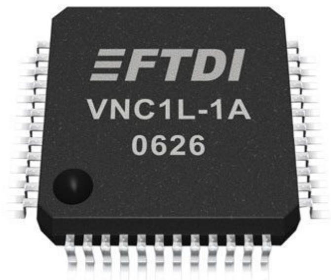
Il chip VNC1L oltre ad essere un host USB, integra al suo interno un microprocessore da 8/32 bit e una memoria flash.
