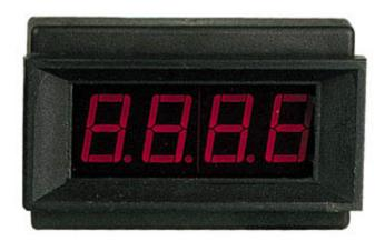
Voltmetro digitale a LED rossi da pannello a 3 1/2 cifre. Mediante l'utilizzo di circuiti dedicati esterni può essere utilizzato come termometro, misuratore di PH, luxmetro, Wattmetro, capacimetro, ecc. Tensione massima misurabile: 500 V. Alimentazione 5 Vdc.
