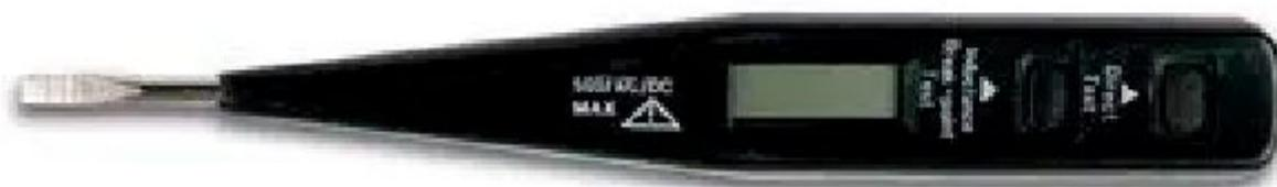
Consente di effettuare misurazioni senza diretto contatto di tensioni comprese tra 12 e 220 V (AC o DC). Permette di eseguire test di messa a terra e di individuare interruzioni di linea. Lo strumento funziona senza alcuna batteria di alimentazione. Lunghezza 125 mm.
