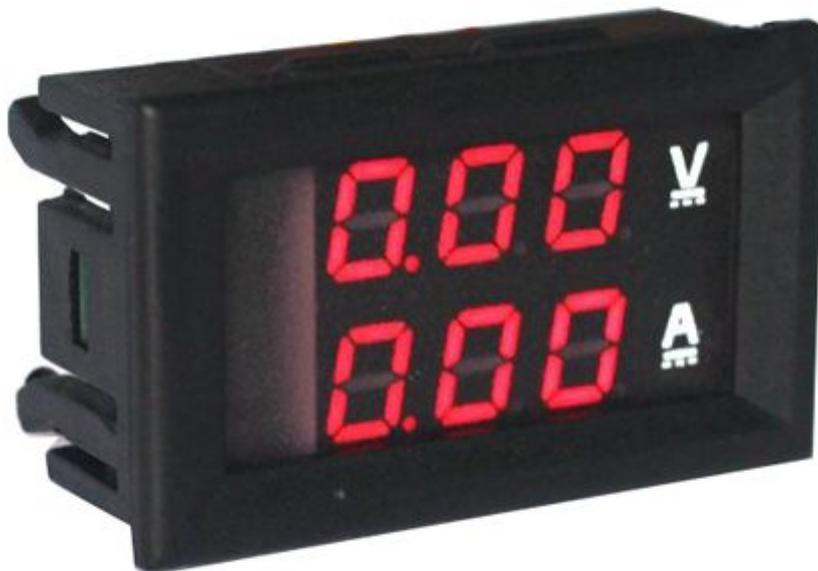
Piccolo strumento da pannello con display a LED rossi. È in grado di visualizzare tensioni continue fino a 100 volt e correnti continue fino a 10 A. Alimentazione: da 4,5 a 30 Vdc.
